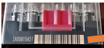
Rack ID 側面印字部
