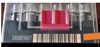
Rack ID 側面印字部
