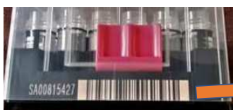
Rack ID 側面印字部
