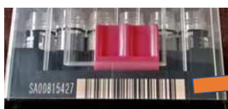
Rack ID 側面印字部
